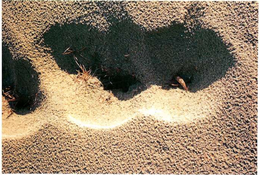
写真(芦-31) 小穴部分が噴砂口<浜風町>
